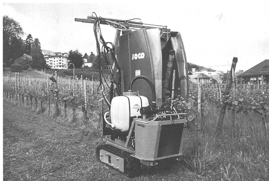
Pour une application optimale, la technique «en tunnel» offre la meilleure des garanties (dérive limitée).
