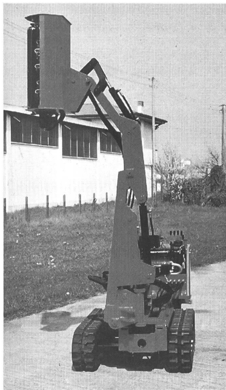
Prototype d'une débroussailleuse. Le manque de stabilité de la chenillette peut causer des problèmes.
