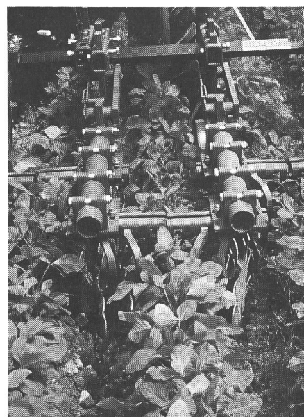
Fig. 3. La sarcleuse étoile avec socs fouilleurs permet d'ameublir et de retourner la terre et de lutter contre les adventices. Un léger buttage des lignes n'a pas eu d'incidences négatives sur le battage avec des plantes bien dressées (à droite). Des pierres en surface ont rendu la récolte plus difficile.
