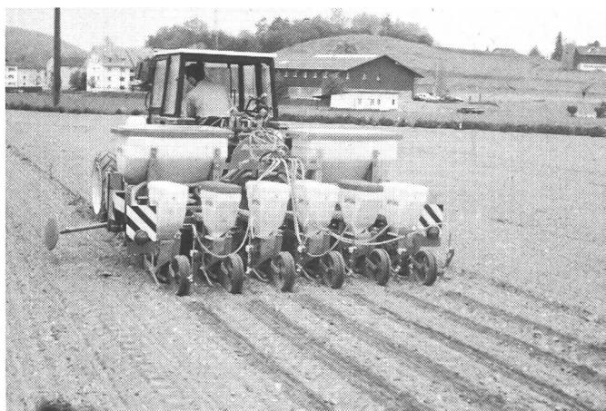
Fig. 1. Le semis exact monograine du soja avec traitement herbicide en bandes simultané facilite la lutte contre les mauvaises herbes. Un peuplement pratiquement exempt d'adventices après deux passages avec la sarcluse (à droite).
