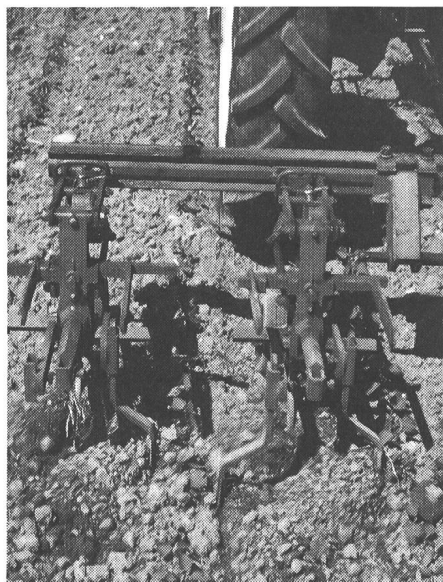
Fig. 2. La sarcleuse à socs pour betteraves permet également de lutter efficacement contre les mauvaises herbes dans le soja. De gauche à droite: Premier et second passages, largeur du jeu de sarclage de 31 cm pour les lames coudées et de 28 cm pour les socs en patte d'oie.
