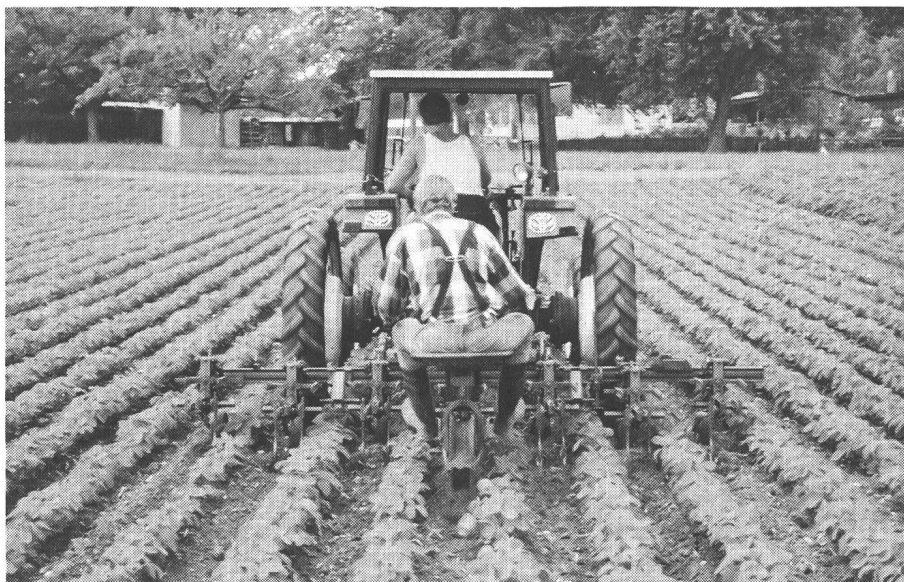
Fig. 2. La sarcleuse à socs pour betteraves permet également de lutter efficacement contre les mauvaises herbes dans le soja. De gauche à droite: Premier et second passages, largeur du jeu de sarclage de 31 cm pour les lames coudées et de 28 cm pour les socs en patte d'oie.
