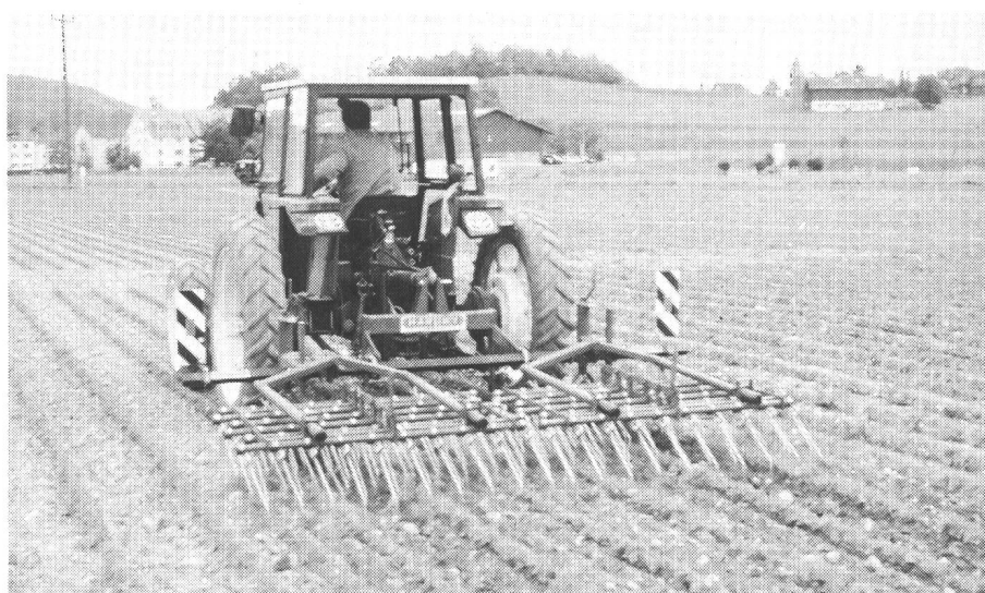
Fig. 3. La sarcleuse étoile avec socs fouilleurs permet d'ameublir et de retourner la terre et de lutter contre les adventices. Un léger buttage des lignes n'a pas eu d'incidences négatives sur le battage avec des plantes bien dressées (à droite). Des pierres en surface ont rendu la récolte plus difficile.
