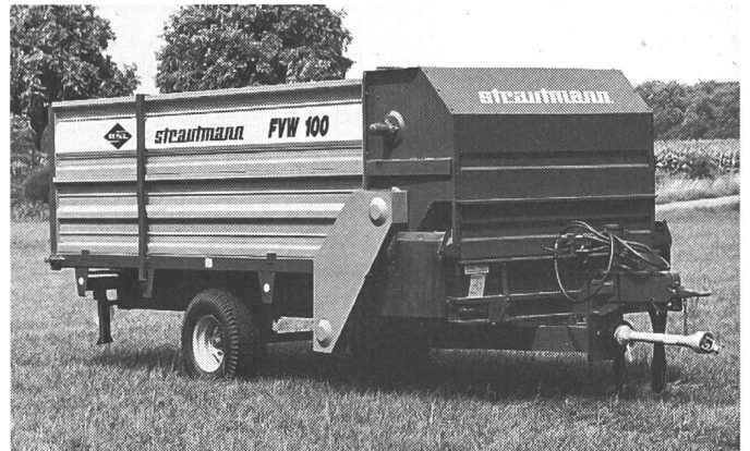
Distributrice de fourrage Strautmann avec fond racleur entraîné hydrauliquement et bande transversale.
