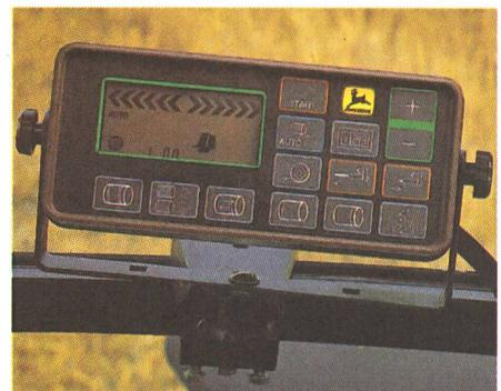
*L'automatisation du processus de liage et la surveillance de la machine sur le moniteur facilitent la tâche du conducteur.*
