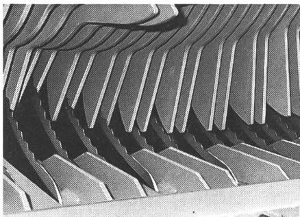
*Aussi bien pour les presses à balles rondes que pour celles à balles rectangulaires, les dispositifs de coupe travaillent en combinaison avec un système d'alimentation rotatif semblable à celui des autochargeuses de grandes dimensions.*
