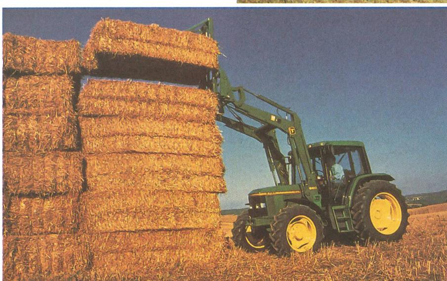
*Pour les tas de hauteur importante ou pour le chargement des camions, le frontal est idéal et peut être équipé, au besoin, de griffes pivotantes.*
