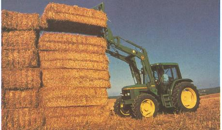
Pour les tas de hauteur importante ou pour le chargement des camions, le frontal est idéal et peut être équipé, au besoin, de griffes pivotantes.
