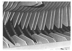
Aussi bien pour les presses à balles rondes que pour celles à balles rectangulaires, les dispositifs de coupe travaillent en combinaison avec un système d'alimentation rotatif semblable à celui des autochargeuses de grandes dimensions.
