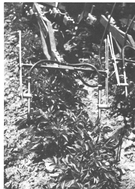
Fig. 5. Le traitement en bandes avec deux buses Excenter à jet plat (Teejet OC-02) par ligne, a été efficace pour toutes les années d'essai. Gauche/droite: application de Sencor ou de Titus.
