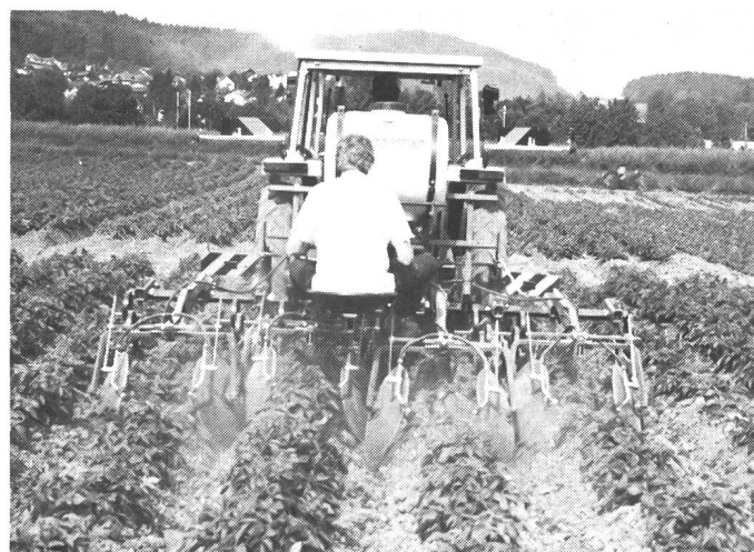
Fig. 3. La bineuse universelle permet de herser, sarcler, butter et traiter en bandes en un passage. Premier et troisième passage.
