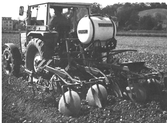
Fig. 3. La bineuse universelle permet de herser, sarcler, butter et traiter en bandes en un passage. Premier et troisième passage.
