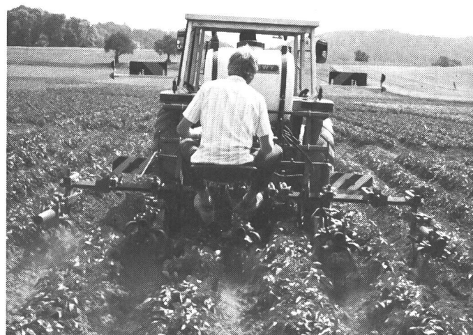
Fig. 4. L'action de la sarcluse-étoile s'est caractérisée par un bon ameublissement du sol et une bonne structure grumeleuse ainsi que par un contrôle efficace des mauvaises herbes. Premier et troisième passage lorsque le degré d'humidité du sol est favorable.
