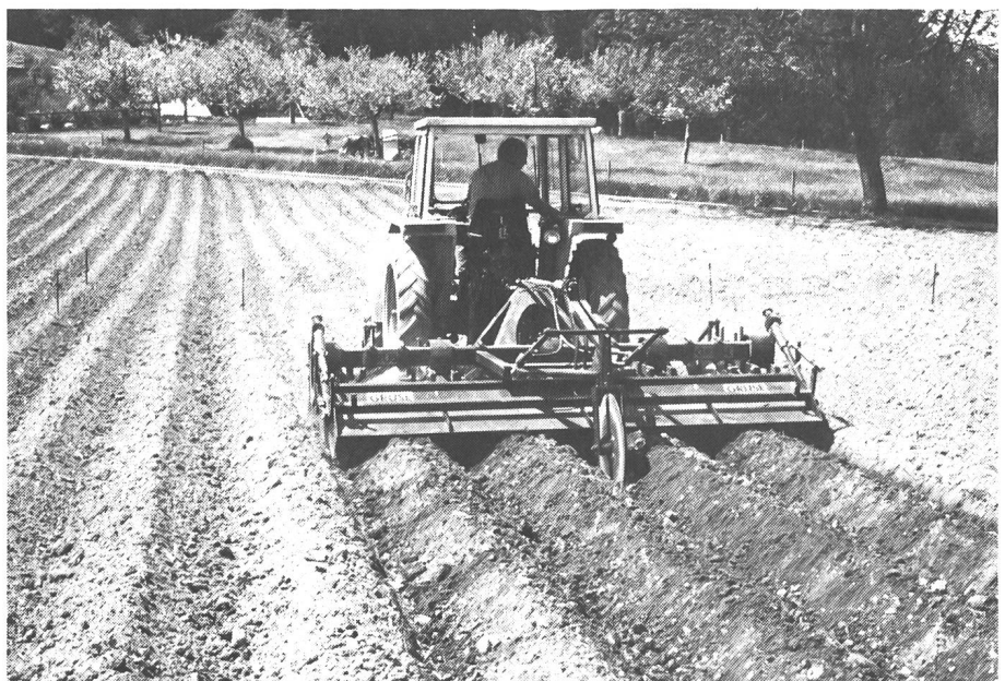
Fig. 2. La sarclouse-butteuse avec versoir et compensateur de dévers hydraulique permet de constituer des buttes d'un volume conséquent en deux passages. Un tracteur 44 kW quatre roues motrices et pneus de 10 pouces a également suffi pour les sols lourds.
