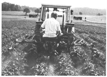
Fig. 4. L'action de la sarcleuse-étoile s'est caractérisée par un bon ameublissement du sol et une bonne structure grumeleuse ainsi que par un contrôle efficace des mauvaises herbes. Premier et troisième passage lorsque le degré d'humidité du sol est favorable.
