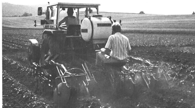
Fig. 1. L'utilisation de la bineuse universelle permet d'atteindre les trois objectifs que constituent la formation des buttes, le travail du sol et un contrôle efficace des mauvaises herbes (à droite).
