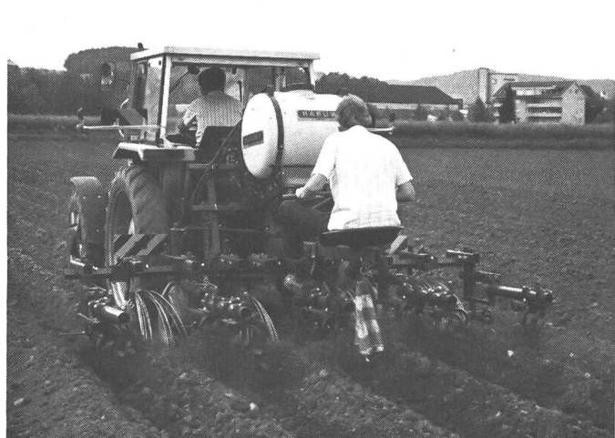
Fig. 4. L'action de la sarcluse-étoile s'est caractérisée par un bon ameublissement du sol et une bonne structure grumeleuse ainsi que par un contrôle efficace des mauvaises herbes. Premier et troisième passage lorsque le degré d'humidité du sol est favorable.
