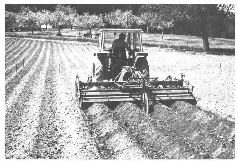
Fig. 2. La sarcleuse-butteuse avec versoir et compensateur de dévers hydraulique permet de constituer des buttes d'un volume conséquent en deux passages. Un tracteur 44 kW quatre roues motrices et pneus de 10 pouces a également suffipour les sols lourds.
