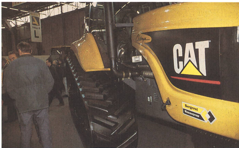
Les chenilles réduisent la pression spécifique sur le sol (observé chez Caterpillar, représentant à Genève).
