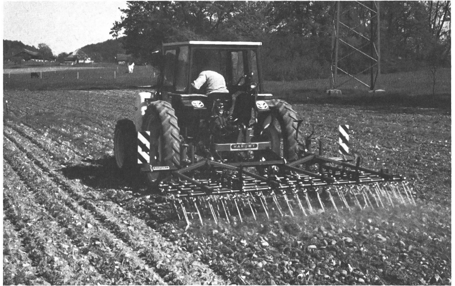
Fig. 4. La réalisation de trois passages ponctuels à la herse-étrille permet de réduire suffisamment les mauvaises herbes et d'obtenir un entretien efficace du sol. En haut: deuxième passage; au milieu: troisième passage; hauteur des plantes: respectivement 6 cm et 15 à 18 cm. En bas: parcelles non traitée et travaillée avec la herse-étrille, 1994.
