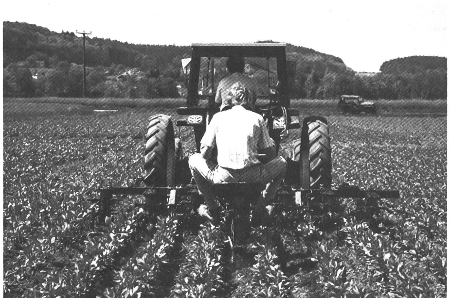
Fig. 2. La sarcleuse à socs pour betteraves se prête également à l'utilisation dans la culture de la féverole. De gauche à droite: premier et deuxième passage, largeur du jeu de sarclage de 33 cm pour les lames coudées et de 28 – 30 cm pour les socs à patte d'oie.
