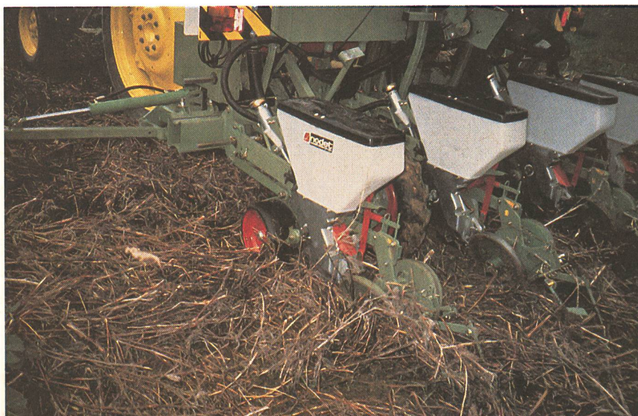
Semis direct dans une culture dérobée sensible au gel. Les machines disponibles sur le marché en Europe actuellement ne sont pas conçues pour le semis direct.
