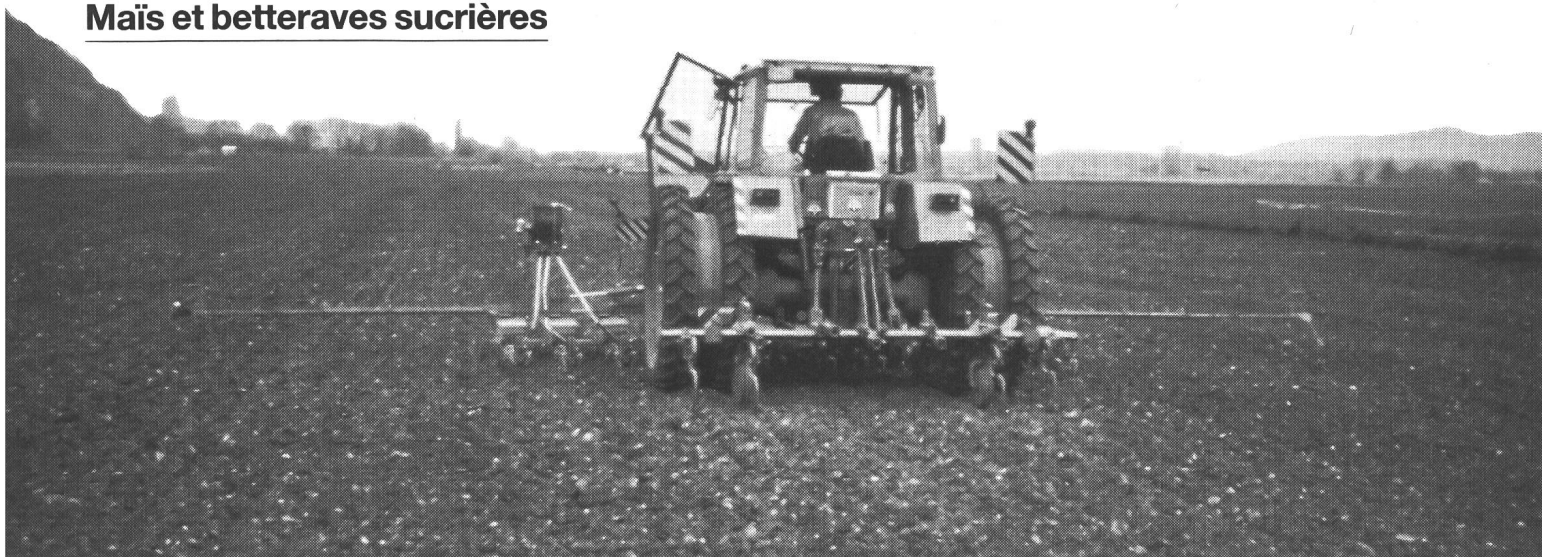
Largeur de travail importante avec les semoirs monograins mécaniques en raison du poids modéré.
