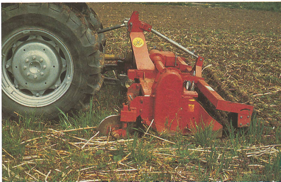
Préparation du lit de semences avec une herse rotative à axe horizontal pour semis sous litière.
