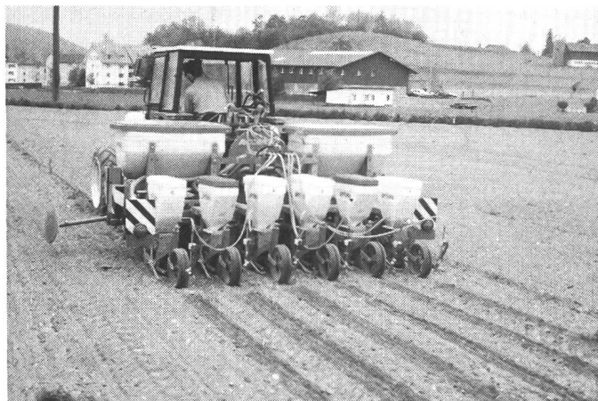
Fig. 1: Le semis exact monograins du soja avec traitement herbicide en bandes simultané facilite la lutte contre les mauvaises herbes. Un peuplement pratiquement exempt d'adventices après deux passages avec la sarleuse (à droite).
