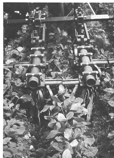
Fig. 3: La sarclouse étoile avec socs fouilleurs permet d'ameublir et de retourner la terre et de lutter contre les adventices. Un léger buttage des lignes n'a pas eu d'incidences négatives sur le battage avec des plantes bien dressées (à droite). Des pierres en surface ont rendu la récolte plus difficile.
