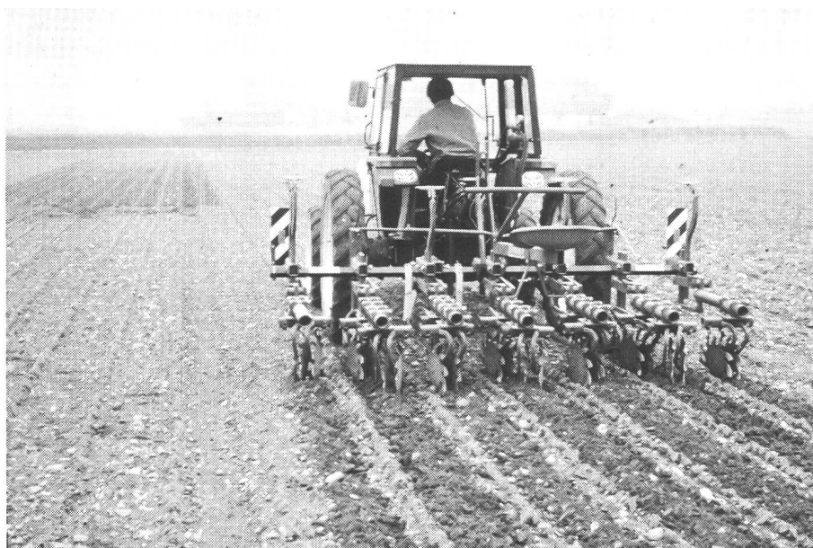
Fig. 3: La sarclouse étoile avec socs fouilleurs permet d'ameublir et de retourner la terre et de lutter contre les adventices. Un léger buttage des lignes n'a pas eu d'incidences négatives sur le battage avec des plantes bien dressées (à droite). Des pierres en surface ont rendu la récolte plus difficile.
