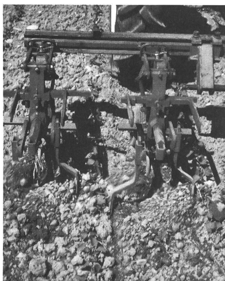
Fig. 2: Lutte efficace contre les mauvaises herbes. A gauche et à droite: premier et second passages, largeur de sarclage de 31 cm pour les lames coudées et de 28 cm pour les socs «patte d'oie».
