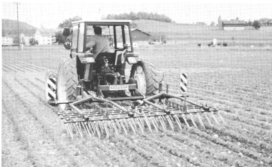
Fig. 4: Le hersage n'a été satisfaisant que presque uniquement en combinaison avec le sarclage. Une vitesse modérée, une faible pression des dents et un contrôle attentif du travail sont vivement recommandés.
