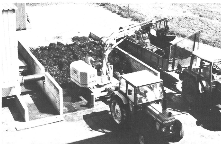
Fig. 8. Chargement d'un épandeur de fumier avec du fumier fermenté: l'épandage de la matière fermentée sur les champs peut se faire sans problème à l'aide d'épandeurs de fumier conventionnels.
