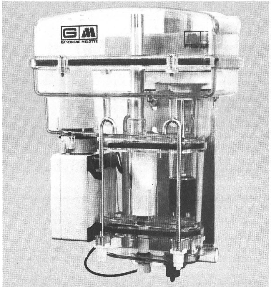
Fig. 11. Le compteur à lait Gascoigne MR 2000 est identique à l'appareil de mesure Happel MM3.
