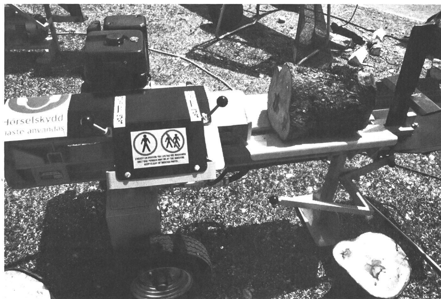
Les commandes bimanuelles doivent permettre de tenir la bûche et de déclencher le fendage sûrement et confortablement. Les fendeuses à coin doivent être munies de dispositifs de rattrapage.
