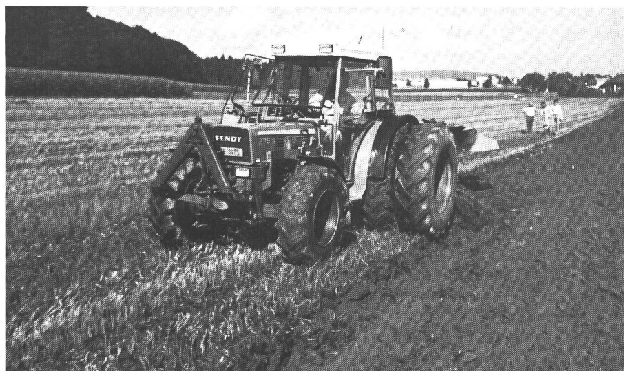
Les labours «offset» protègent le sol mais demandent une grande précision de guidage ... Grâce au montage de roues jumelées et de poids frontaux, le conducteur améliore nettement le guidage du tracteur. (Photo: Th. Anken, FAT)
