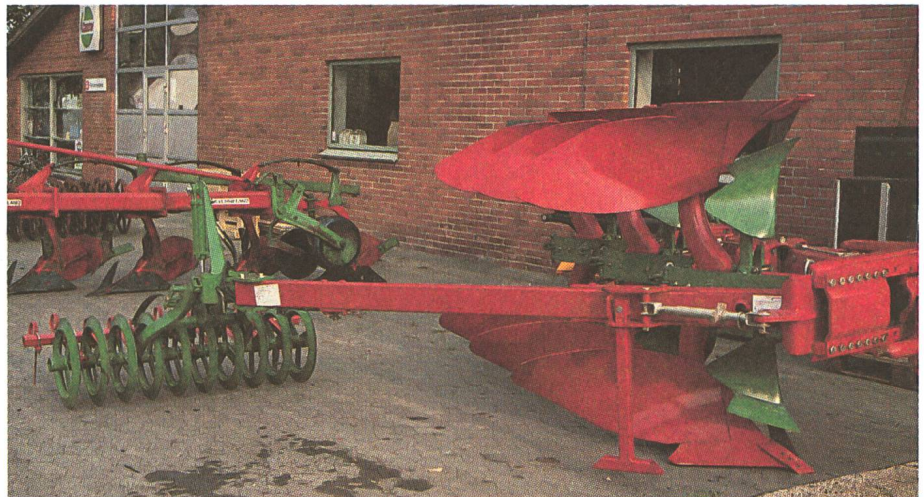
L'outil combiné à la charrue permet d'éviter un passage. Avec ce bras de maintien du rouleau squelette particulièrement stable (avec système rotatif), une partie du poids de la charrue se reporte sur le rouleau squelette. (Photo: Kramer)
