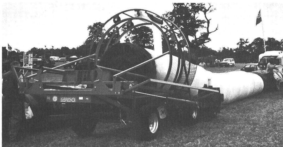
Avec cette méthode d'enrubannage la quantité de plastique est réduite de moitié. Elle ne vaut la peine qu'à condition que de grandes quantités soient récoltées simultanément. (Photos: FAT)
