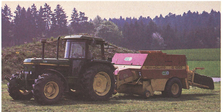
Les presses à balles rectangulaires sont des machines lourdes de 4 à 8 t de poids vide qui impliquent l'utilisation de tracteurs puissants (75 à 90 kW). Les performances de ces machines ainsi que la densité des balles sont très élevées.
