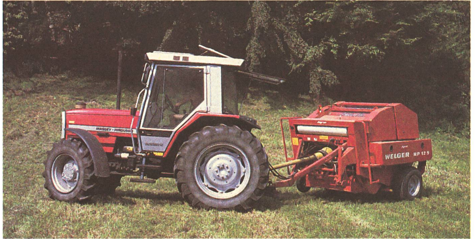
Les presses à balles rondes sont des machines légères. C'est pourquoi elles sont appropriées en terrain d'une déclivité moyenne. Les balles doivent cependant être déchargées à un endroit plat.
