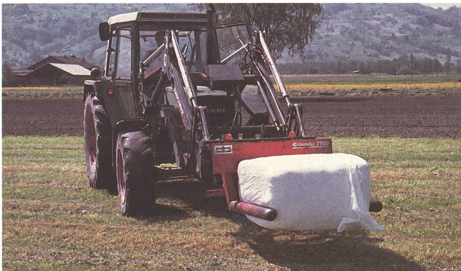
Les grosses balles se manutentionnent aisément au moyen du tracteur. La pince à balles permet de ménager les balles enrubannées.
