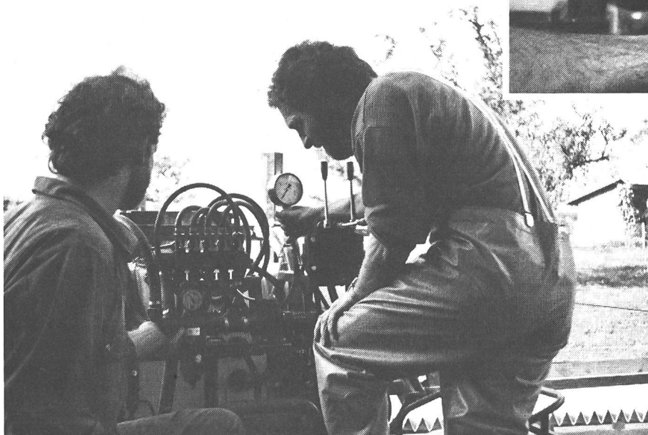
Contrôle du manomètre et de la batterie de commande.
