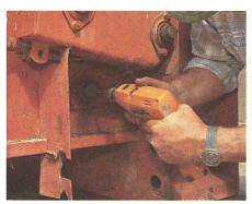
5. Si un «arrache» est à disposition, marquer le centre de l'axe avec un pointeau (s'il n'est pas encore marqué) puis percer un cône pour tenir l'«arrache».
