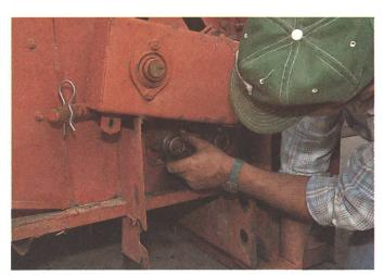
2. Démonter la cage avant du palier.
