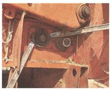
4. Si aucun «arrache» n'est disponible, extraire le roulement avec 2 minutes (leviers à pneus) en faisant levier sur le châssis de la machine. Taper un bon coup sur l'axe pour débloquer le roulement. S'il ne vient pas, chauffeur violemment le roulement avec un chalumeau pour qu'il se dilate et ainsi cède.
