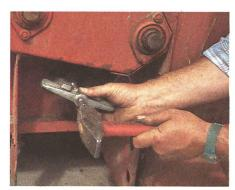
6. Bien fixer les mâchoires de l'«arrache» sur le cage arrière du palier ou, mieux encore, si cela est possible, directement sur le roulement. S'il se fait prier, taper un bon coup sur la vis de l'«arrache» et s'il ne se détache toujours pas, chauffer comme sous point 4.
