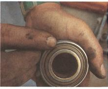
7. Chaque roulement à bille s'identifie par un numéro qui se trouve sur le champ extérieur du roulement. Ce numéro est indispensable pour la commande du nouveau roulement.
