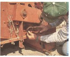
10. Présenter la bague excentrique et la bloquer avec un chasse (10a) dans le sens des aiguilles d'une montre) et serrer la vis imbus de la baque (10b).
