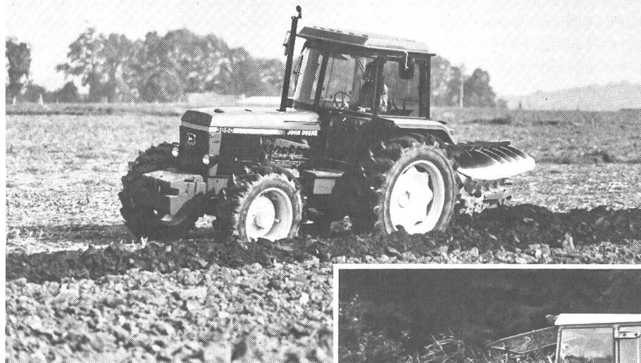
Des pneus radiaux peu gonflés et remplis d'eau et des poids frontaux accentueront la force de traction du couple du moteur. De plus, il protègeront le sol par une plus grande adhésion en limitant le patinage.
