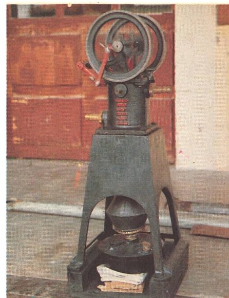
Moteur à air chaud, construit probablement vers le fin du 19 e siècle
