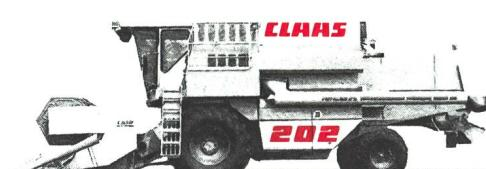
MEGA existe maintenant dans toutes les catégories avec des largeurs de barre de coupe de 3,90 m à 7,50 m, des puissances de moteur de 118 kW (160 CV) à 199 kW (270 CV) et des volumes du réservoir à grains de 5200 l à 7500 l. Le programme complet est établi pour des largeurs de batteur de 1,32 m à 1,58 m.
