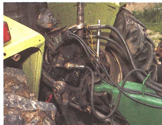
Tracteur: transmission universelle de l'énergie par l'hydraulique, la prise de force et même par la batterie
