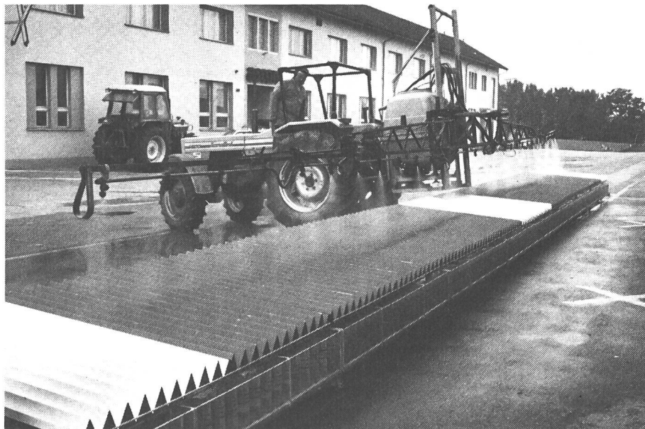
Contrôle de la régulation transversale sur le dosimètre. (Photos: Roger Berset)
