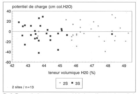
Fig. 5. Teneur volumique en eau et potentiel de charge 10 cm sous la semelle de labour. Lorsque le sol se ressuie, le potentiel de charge diminue; inversément, lorsque le sol se remplit d'eau, il augmente, atteint puis dépasse zéro. Le sol est alors saturé.
