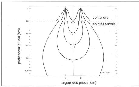
Fig. 1. Propagation des contraintes en sol hétérogène. Exemple: décolleteuse, pneumatique 9.5 R 48/8, charge à l'essieu 6,6 t.
