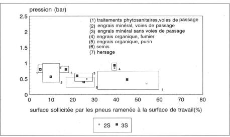
Fig. 3. Contrainte de charge à 40 cm et surface sollicitée par les pneus lors du hersage, des traitements phytosanitaires et des épandages d'engrais
