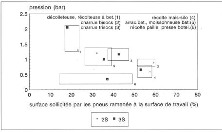
Fig. 2. Contrainte de charge à 40 cm et surface sollicitée par les pneus pour les travaux de labour et de récolte
