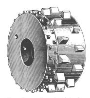
Deux lignes d'ergots déplacées avec une forme optimalisée.
