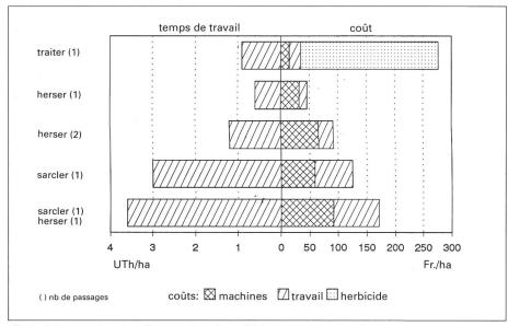
III. 4: Temps de travail et coûts des différents moyens de lutte contre les mauvaises herbes dans le colza avec location de la sarcleuse et de la herse-étrille (sans les frais fixes du tracteur et du pulvérisateur). Selon rapport FAT no 436: Tracteur 33 kW (45 CV), pulvérisateur 12 m, Sarcleuse (6 m) Fr. 27.—/ha, herse-étrille (3 m) Fr. 44.—/ha, travail Fr. 22.—/UTh.
