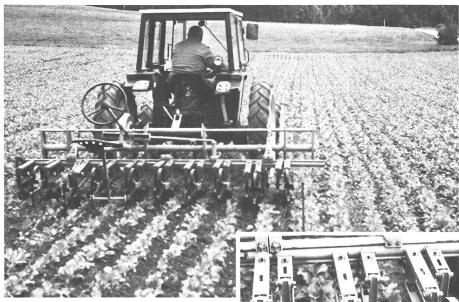
III. 2: La sarcleuse permet de lutter contre les mauvaises herbes situées entre les rangs et provoque un petit amoncellement de terre au pied des plantes.
