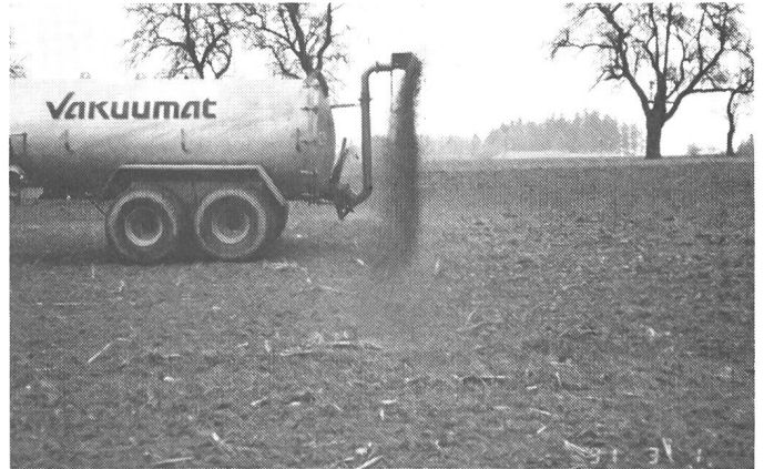
Fig. 5. Citerne à pression avec déflecteur: le fait de pouvoir baisser ou monter le déflecteur permet d'adapter la largeur de travail suivant la nécessité, dans un secteur variant entre 10 et 14 m. Ce type de distributeur est tout à fait approprié à l'épandage du lisier dans les grandes cultures dans lesquelles on a laissé des passages.
