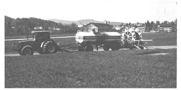
Fig. 15. Arrosage de lisier dans une culture de blé: la remorque-citerne placée à côté de l'arroseur automatique sert de station intermédiaire pour le lisier. La pompe à piston tournant entraînée par le tracteur permet de propulser le lisier dans l'arroseur. Cette technique, qui est loin d'être bon marché, n'est valable que si elle est partagée entre plusieurs exploitations.
