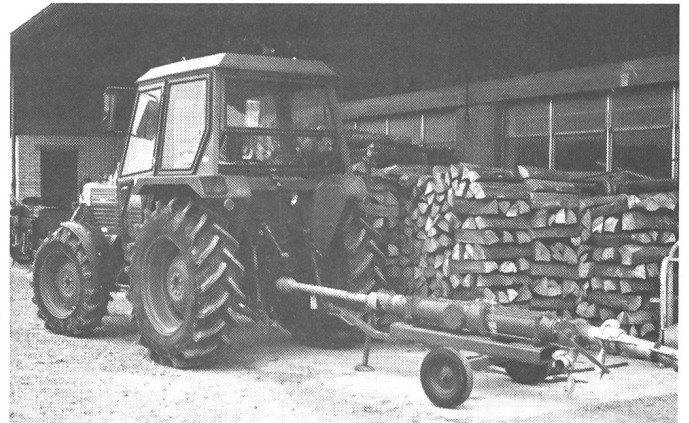
Fig. 7. Pour le purinage par tuyau, les pompes à vis sont aujourd'hui les plus utilisées. Pour garantir une puissance suffisante, elles sont souvent entraînées par la prise de force du tracteur. Pour éviter les dégâts que pourrait causer une obstruction de la conduite, les pompes devraient être équipées du côté refoulement d'une sécurité en cas de surpression.
