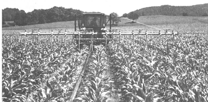
Fig. 12. Les rampes d'épandage à tuyaux souples sont particulièrement avantageuses dans les grandes cultures: haute précision dans la répartition, pas de végétation souillée, moins de pertes d'ammoniac. Elles doivent cependant pouvoir être utilisées suffisamment.
