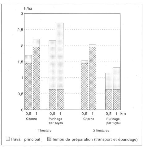
Fig. 2. Travail nécessaire pour l'épandage (30 m³/ha) sur des surfaces de 1 resp. de 3 hectares, au moyen d'une citerne à pression (4000 l) et purinage par tuyau (débit 800 l/min) pour des champs éloignés de 500 resp. de 1000 m.
