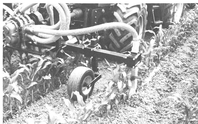
Fig. 13. Epandeur enfouisseur en lignes (5 lignes) en montage frontal: la pompe intégrée répartit le lisier depuis la citerne sur les différents injecteurs. L'enfouissement direct permet d'éviter pratiquement toutes les pertes d'azote sous forme gazeuse.
