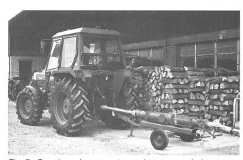
Fig. 7. Pour le purinage par tuyau, les pompes à vis sont aujourd'hui les plus utilisées. Pour garantir une puissance suffisante, elles sont souvent entraînées par la prise de force du tracteur. Pour éviter les dégâts que pourrait causer une obstruction de la conduite, les pompes devraient être équipées du côté refoulement d'une sécurité en cas de surpression.
