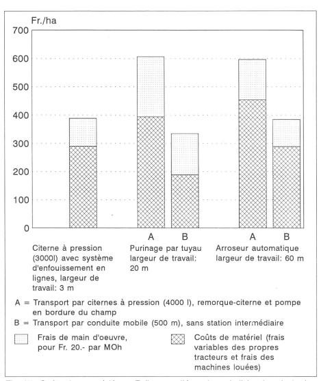
Fig. 17. Coûts des procédés en Fr./ha pour l'épandage du lisier dans les cultures de maïs (champs d'une longueur de 200 m, distance des champs à l'exploitation 500 m, 50 m³/ha).
