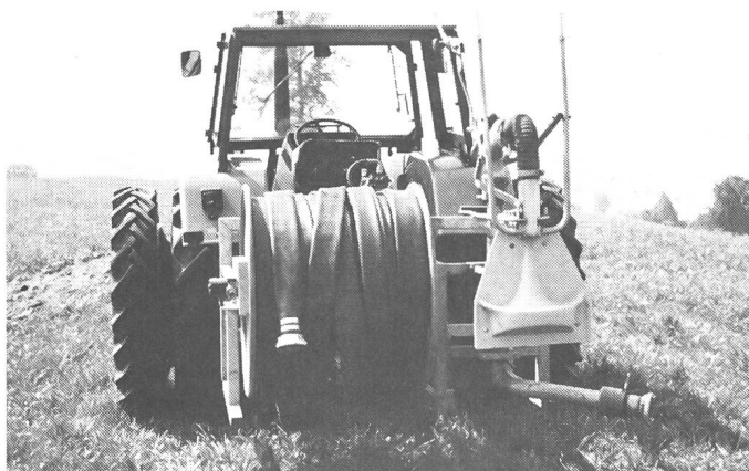
Fig. 10. Les enrouleurs combinés (enrouleur avec distributeur automatique) présentent un avantage: l'enrouleur n'a pas besoin d'être dételé une fois les tuyaux déroulés. Pour les surfaces difficilement accessibles, le déflecteur peut être branché sur commande manuelle depuis la cabine du tracteur.
