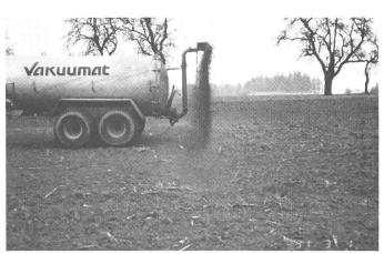
Fig. 5. Citerne à pression avec déflecteur: le fait de pouvoir baisser ou monter le déflecteur permet d'adapter la largeur de travail suivant la nécessité, dans un secteur variant entre 10 et 14 m. Ce type de distributeur est tout à fait approprié à l'épandage du lisier dans les grandes cultures dans lesquelles on a laissé des passages.
