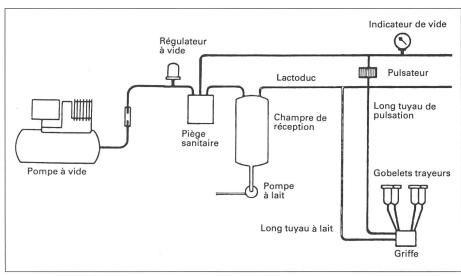
Schéma d'une installation de traite à pots. Cette installation se distingue par sa simplicité aussi bien dans son fonctionnement que dans l'entretien. Elle est conçue pour de petites et moyennes exploitations.
