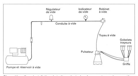
Disposition d'une installation de traite en lactoduc. Les avantages de ce système proviennent de l'allégement et de la rationalisation de la traite. Comparé à la traite en pots, l'influence de la mécanique sur le lait est plus grande. L'installation requiert de hautes exigences au nettoyage et à l'entretien.
