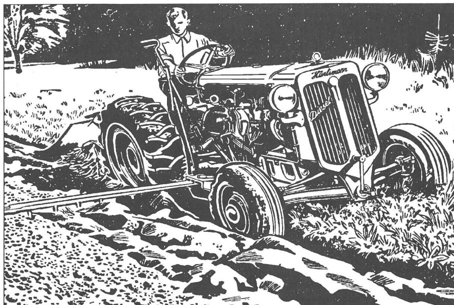
*Il y a 50 ans, le légendaire constructeur de tracteurs Hürlimann déposait un brevet, dans tous les pays industrialisés, pour sa découverte «herse latérale actionnée par prise de force au moteur». En un seul passage, ce procédé permettait de labourer et de herser. Ce tracteur et bien d'autres constructions de pionniers suisses du secteur agricole seront exposés lors de la manifestation qui aura lieu à Tänikon/Aadorf les 6 et 7 août 1994.*
