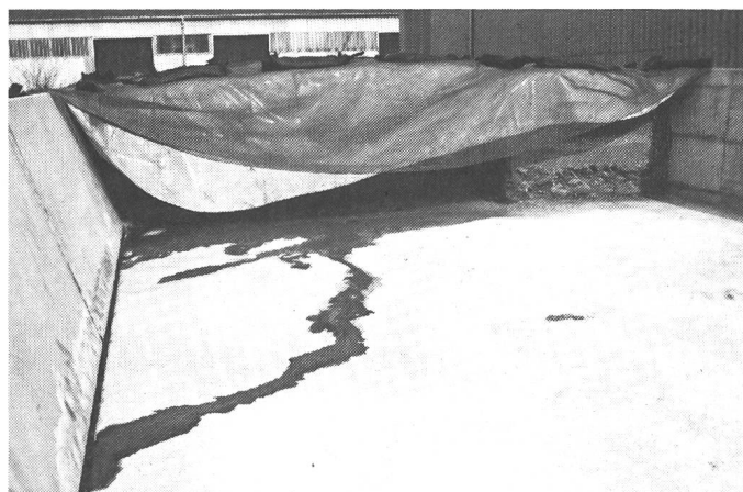
Fig. 2: Dispositif d'essai de silo-couloir à la FAT. On distingue bien la faible quantité de jus de fermentation pendant le désilage de l'ensilage de maïs, qui avait une teneur en matière sèche d'à peine 30% au départ.
