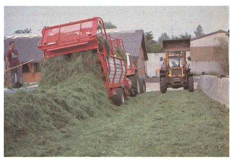
Il faut compter au moins 1 m de longueur de silo par m³ de volume d'autochargeuse, sinon le tas déchargé est trop haut.
