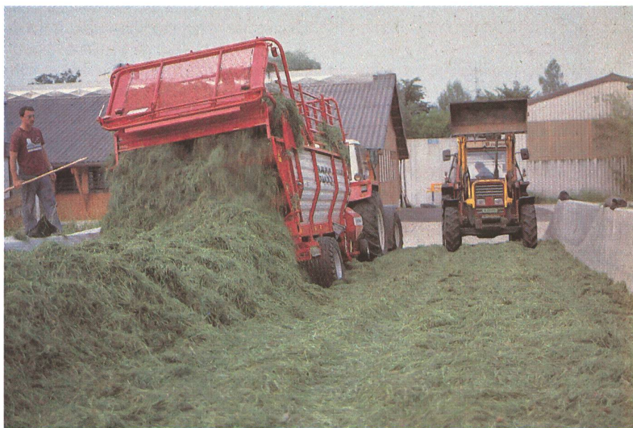
Il faut compter au moins 1 m de longueur de silo par m 3 de volume d'autochargeuse, sinon le tas déchargé est trop haut.
