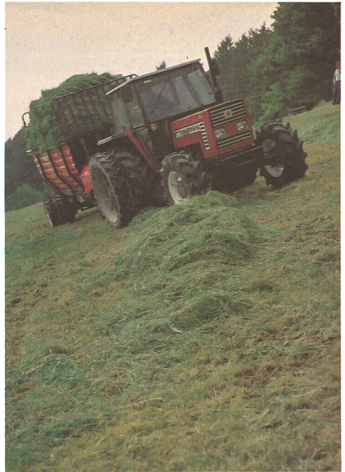
Le tracteur, équipé de roues jumelées et d'un essieu-moteur sur l'autochargeuse prouve sa polyvalence, même en montagne.
