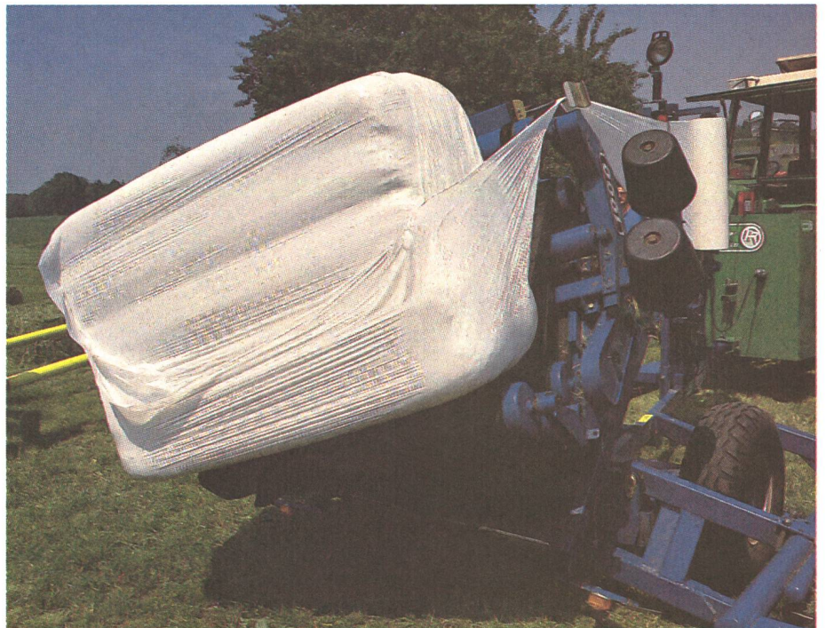
La solution idéale pour une récolte de fourrage qui ne tient compte ni du volume de la grange ni de la surface à faucher: l'ensilage en balles rondes ou carrées. Sur les terrains à fortes déclivités, il faudra préférer le système des balles carrées puisque les rondes pourraient dévaler la pente.
