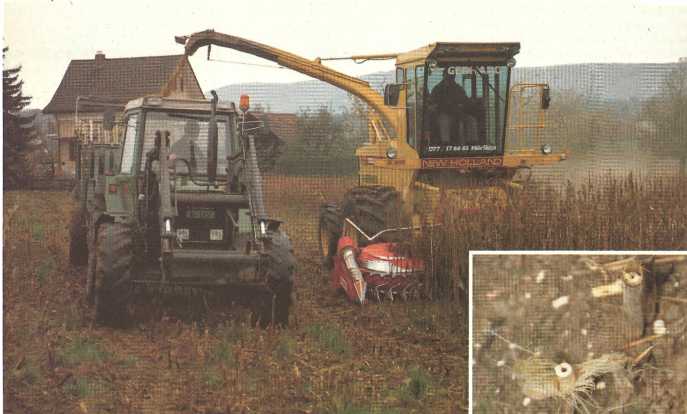
Kénaf et roseau de Chine: l'ensileuse équipée d'un pick-up Kamper semble être la machine la mieux adaptée pour venir à bout de cette masse épaisse et fibreuse.
