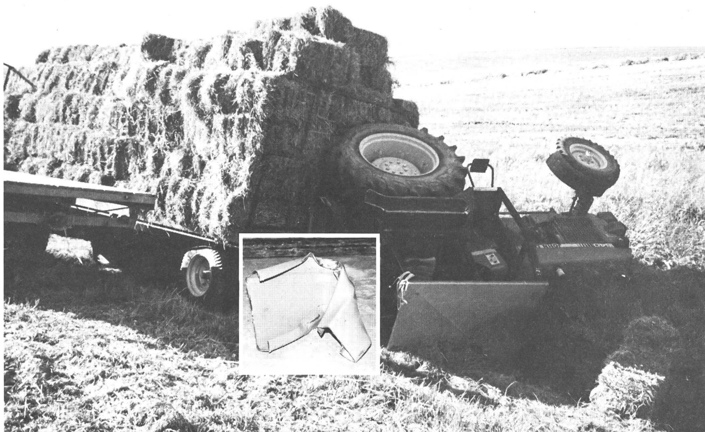
Chance dans la malchance: pas de blessé et des dommages plutôt minimes grâce aux arceaux protecteurs montés sur le tracteur. Le détail de la photo montre le timon plié sur l'une des barres inférieures.
