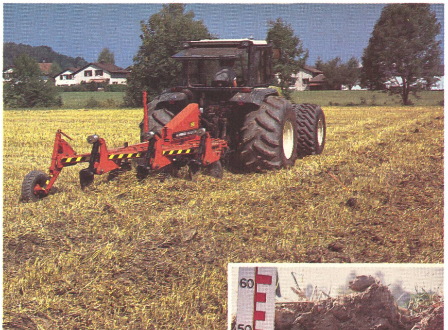
Décompacteur paraplow. Les socs placés en biais tranchent le sol en le soulevant quelque peu. Dans les sols lourds, seule l'utilisation d'un tel outil permet l'ameublissement du sol au-dessous de la semelle de labour. Seul en sol friable et chaud, l'activité biologique, permet de consolider la structure obtenue, sans grandes pertes d'eau par évaporation.
