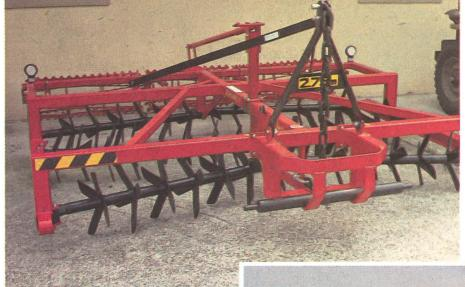
Herse à bêches roulantes. Cette outil universel, aisé à tracter, permet d'obtenir une surface plane en ménageant la structure du sol et à un coût avantageux, cela avec ou sans restes de plantes.
