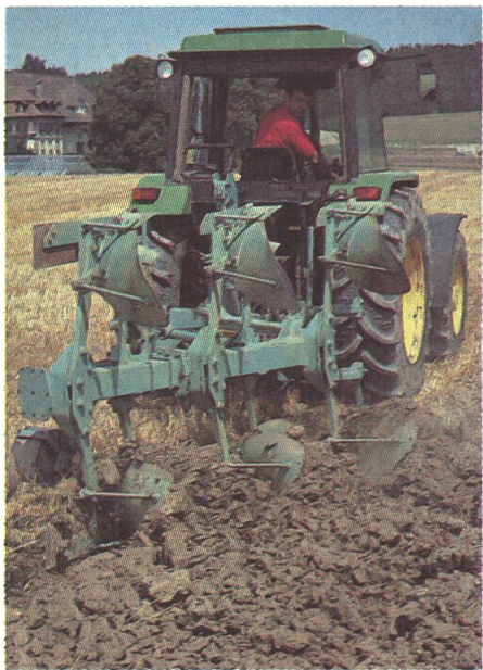
Labour hors sillon. Les études faites à Braunschweig – Völkenrode ont démontré que le fait de rouler dans le sillon lors du labour est ce qui endommage le plus le sous-sol. Si, pour des raisons spécifiques, le labour s'avère nécessaire, les roues motrices devraient reposer sur le sol résistant non labouré (roues jumelées possibles) et non dans le sillon. De plus, le sous-solage devient ainsi superflu!
