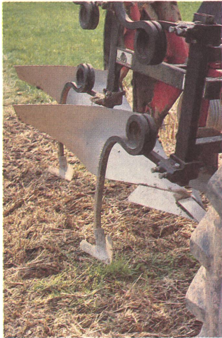
Griffes sous-soleuses. L'avantage de ces dents sur ressort à spirale est l'ameublissement du fond de la raie tassé par le tracteur, juste derrière la roue.
