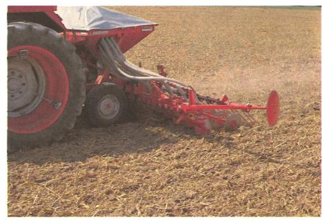
**Technique de semis adaptée.** Le semis sous litière de céréales implique de semer dans des débris incorporés superficiellement. Les socs à disques permettent une mise en place régulière des semences sans risque de bourrage.
