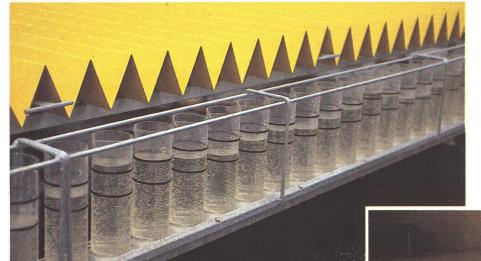
Contrôle de la régularité du débit dans la répartition horizontale: méthode évidente à l'aide du banc d'essai avec mesure de capacité (à gauche). Indication et interprétation digitale de la répartition avec le dispositif qui se déplace de droite à gauche sous la rampe.
