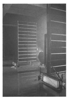
Difficile à déterminer: la bonne répartition verticale des turbo-diffuseurs. A côté de la FAT (qui met son banc d'essai à disposition) seuls les arboriculteurs des cantons d'Argovie, de Lucerne et de Zoug disposent d'un banc d'essai, qu'il utilisent en commun.
