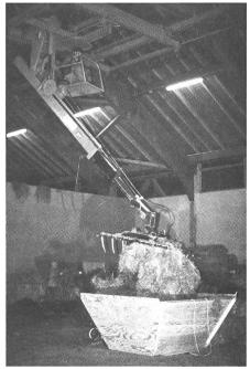
Dans les bâtiments équipés de ponts roulants, les dévaloirs peuvent être équipés d'un entonnoir qui évite les chutes et facilite le déchargement du foin.
