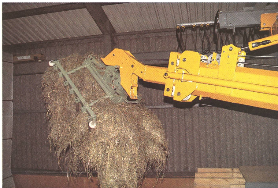
Le fourrage transporté demande environ 50 cm sous la griffe. Le positionnement du pont-roulant en hauteur facilite le remplissage du tas de foin.
