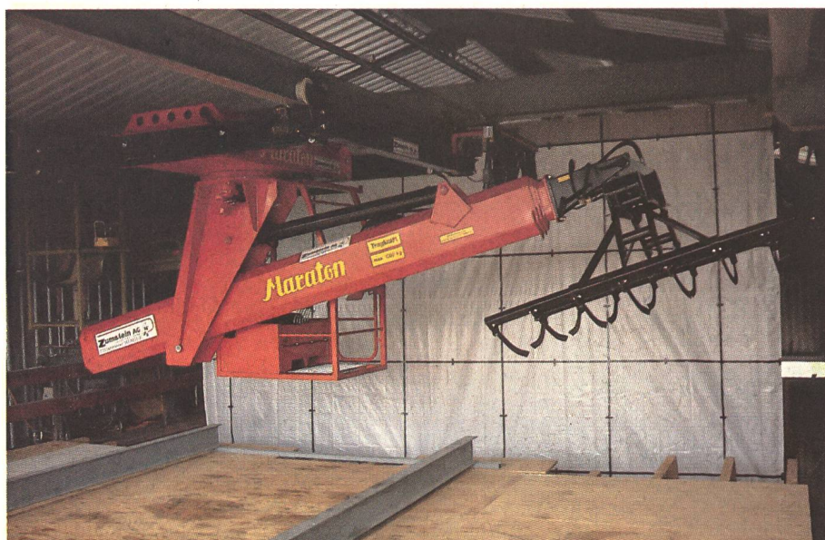
Les ponts-roulant nécessitent un volume de fonctionnement dans le bâtiment (place de passage). La hauteur et la largeur constituent des éléments importants du pont-roulant (bras perpendiculaire à la voie de roulement).
