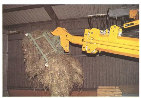
Le fourrage transporté demande environ 50 cm sous la griffe. Le positionnement du pont-roulant en hauteur facilite le remplissage du tas de foin.
