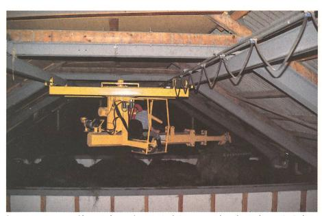
Les mesures ont démontré que les contraintes aux voies de roulement et donc aux rails ainsi qu'au bâtiment sont fort différentes selon le type de pont-roulant et la charge utile.
