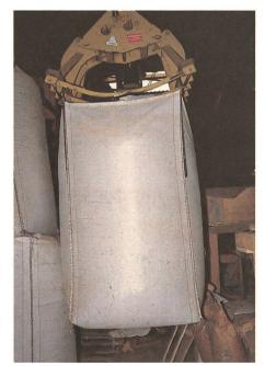
Lorsque des marchandises sont transportées sans que la griffe ne soit découplée, le pont-roulant nécessite une force de levage supérieure de 150-200 kg.
