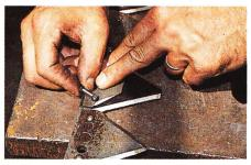
6. Choisir la longueur des rivets: 13 mm pour les sections normales 15 mm pour les sections avec plaques d'usures.
