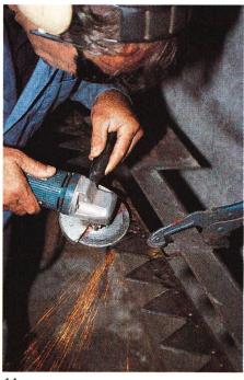
pour une largeur de biseau de 24 mm. Important: les sections ne doivent en aucun cas devenir bleues, sans quoi la dureté de la section diminuera (détrempage).
