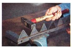
3. ... serrer le dos des sections et l'ajuster en frappant légèrement avec le marteau.
