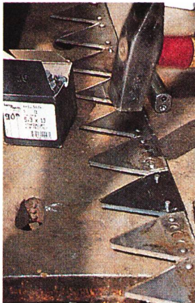
8. Important: marteler d'abord un peu les rivets. De cette façon, ils prendront bien place et se bloqueront légèrement.
