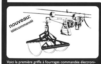
quement pour la préparation du fourrage. Une seule pression sur un bouton et vous transportez le fourrage désiré. Sans changer de place et par simple réglage, vous pouvez choisir 4 postes de chargement sur le tas (sur la meule) et jusqu'à 15 postes de déchargement automatiques. Grâce à un nouveau système d'entraînement, des élévations de 30° (52%) ne posent aucun problème. C'est bien entendu une nouveauté Zumstein!
