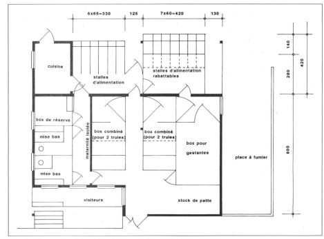
Fig. 2: Coupe horizontale de la porcherie froide utilisée
