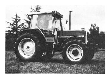
Le nouveau MF 3075 est équipé d'un moteur Perkins turbo, 4 cylindres, 4 litres, de la série bien connue des moteurs 6 cylindres Quadram montés sur les grands tracteurs MF. Ce nouveau modèle se situe dans la ligne des modèles MF 3065 S et MF 3085. Le moteur a une puissance de 95 CV (69,9 kW) à un régime de 2200 tours/min.
