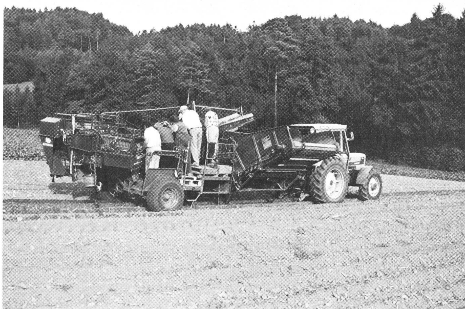
Fig. 1: Grande récolteuse totale à un rang avec organes de séparation performants et installation de tri. Le transbordement des tubercules de petit calibre s'effectue ici aussi en vrac.
