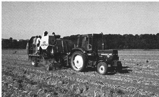
Fig. 2 et 3: En Europe, la récolte en chantier décomposé est principalement pratiquée en deux et quatre rangs. Pour les procédés à deux rangs, on utilise plutôt les andaineurs simples (3a), sans organes de séparation des fanes, et des récolteuses totales à un rang adaptées (3b). Les éléments convoyeurs et de séparation doivent éventuellement être adaptés à un flux de tubercules plus élevé (deux rangs) (3c). Equipés d'un convoyeur latéral adéquat, les andaineurs à deux rangs performants (4a) peuvent également produire un andain à quatre rangs. Ce genre de machine n'est toutefois pourvue que d'un rouleau défaneur qui, lorsque la vitesse de travail est élevée et qu'il y a beaucoup de fanes et d'adventices, arrive au bout de ces capacités. On trouve également à l'étranger des andaineurs à quatre rangs avec convoyeur de fanes à mailles larges. Le ramassage des andains à quatre rangs s'effectue au moyen de ramasseuses chargeuses à deux rangs transformées (4a) ou de machines spéciales.
