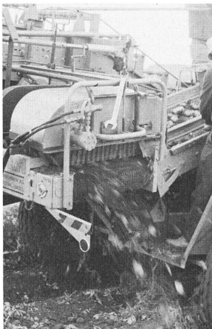
Fig. 12: Nettoyeur vertical à brosses rotatives triples en-dessus d'un convoyeur à ergots (Wisent).
