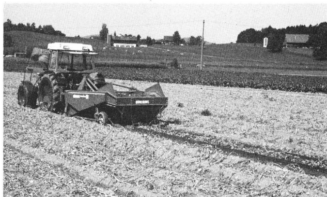
Fig. 2 et 3: En Europe, la récolte en chantier décomposé est principalement pratiquée en deux et quatre rangs. Pour les procédés à deux rangs, on utilise plutôt les andaineurs simples (3a), sans organes de séparation des fanes, et des récolteuses totales à un rang adaptées (3b). Les éléments convoyeurs et de séparation doivent éventuellement être adaptés à un flux de tubercules plus élevé (deux rangs) (3c). Equipés d'un convoyeur latéral adéquat, les andaineurs à deux rangs performants (4a) peuvent également produire un andain à quatre rangs. Ce genre de machine n'est toutefois pourvue que d'un rouleau défaneur qui, lorsque la vitesse de travail est élevée et qu'il y a beaucoup de fanes et d'adventices, arrive au bout de ces capacités. On trouve également à l'étranger des andaineurs à quatre rangs avec convoyeur de fanes à mailles larges. Le ramassage des andains à quatre rangs s'effectue au moyen de ramasseuses chargeuses à deux rangs transformées (4a) ou de machines spéciales.
