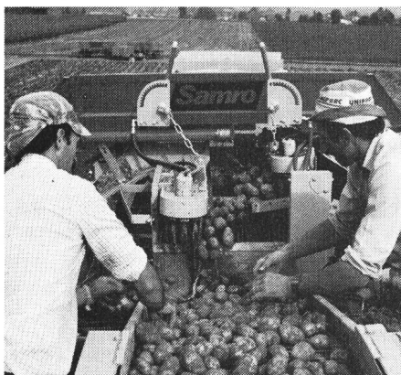
Fig. 11: Nettoyeur horizontal à brosses rotatives en-dessus de deux convoyeurs à ergots (Samro).
