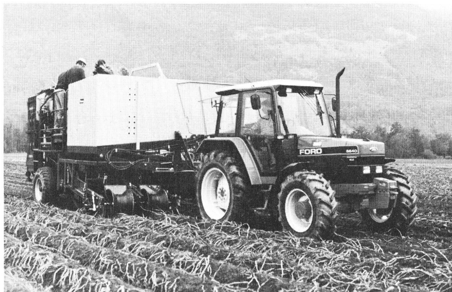
Fig. 5: Récolteuse totale à deux rangs avec organe d'arrachage déporté et compensateur de dévers ainsi que l'équipement complet pour la séparation des corps étrangers, spécialement conçue pour répondre aux exigences de la Suisse (Samro).
