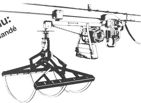
Voici la première griffe à fourrages commandée électroniquement pour la préparation du fourrage. Une seule pression sur un bouton et vous transportez le fourrage désiré. Sans changer de place et par simple réglage, vous pouvez choisir 4 postes de chargement sur le tas (sur la meule) et jusqu'à 15 postes de décharge automatiques. Grâce à un nouveau système d'entraînement, des élévations de 30° (52%) ne posent aucun problème. C'est bien entendu une nouveauté Zumstein!
