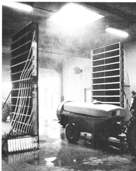
A Saxon et au Centre des Fougères à Conthey, plus de 40 diffuseurs ont passé les tests du banc d'essai de la FAT. (Photo: Guy Bianco)
