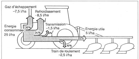
Fig. 1: Flux énergétiques lors de la transformation de l'énergie du carburant en force de traction.
