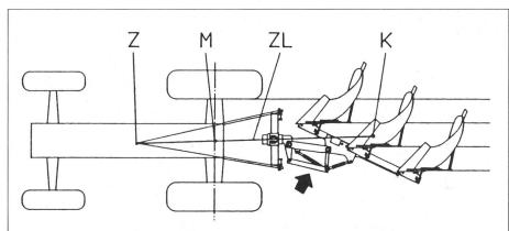
Fig. 4: Point de traction (Z); Point médian de l'essieu postérieur du tracteur (M); Ligne de traction (ZL); Point d'application des forces de traction résultantes.
