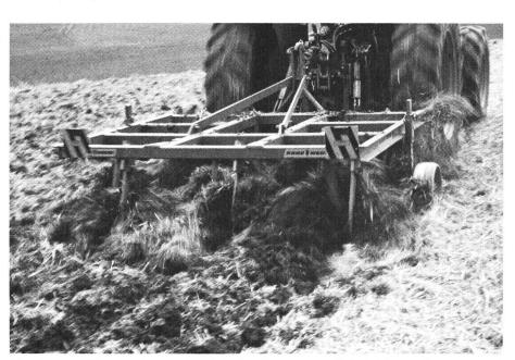
Fig. 3: Le cultivateur à socs bombés (Rab0) a pour effet de bien mélanger le sol.
