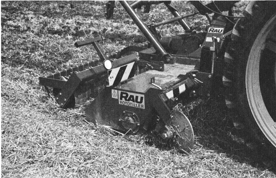
Fig. 18: Avec la herse rotative à axe horizontal (Rau), le sol est travaillé sur toute la surface et de façon intensive. Une vitesse d'avancement aussi élevée et un régime de rotor aussi bas que possible sont recommandés pour tous les outils animés à la prise de force.
