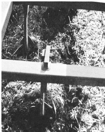
Fig. 2: Sans outil suiveur, le travail superficiel du cultivateur à socs bombés (Rab0) laisse des sillons. Le sol n'est pas travaillé sur la surface entière.
