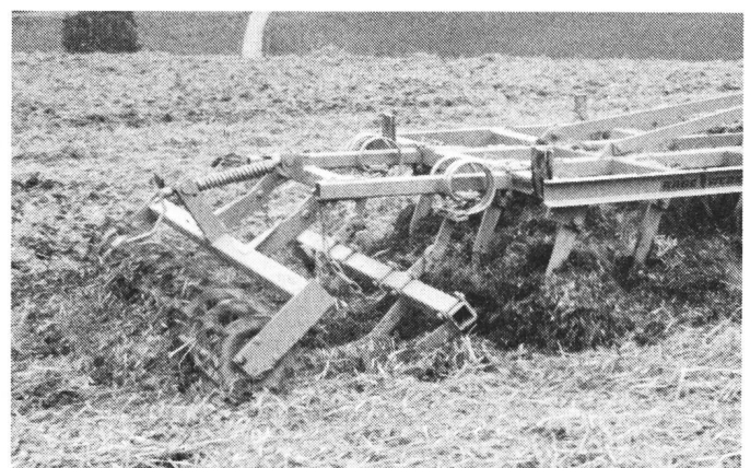
Fig. 4: Les outils suiveurs émiettent et égalisent le sol. Le peigne avec rouleau à lattes (RabR, à droite) le raffermi en plus, contrairement aux bêtes roulantes (RabB, à gauche).
