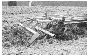
Fig. 4: Les outils suiveurs émiettent et égalisent le sol. Le peigne avec rouleau à lattes (RabR, à droite) le raffermit en plus, contrairement aux bêches roulantes (RabB, à gauche).
