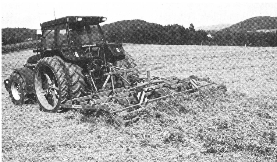
Fig. 10: Pour le transport, le vibroculteur (Koec) est replié verticalement. Le maniement ne pose pas de problèmes.
