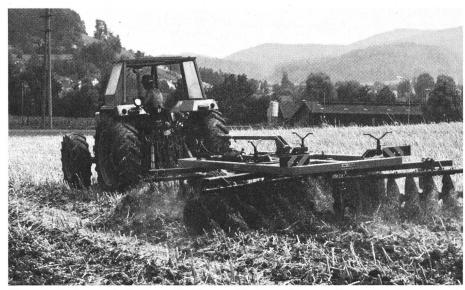
Fig. 15: La herse à disques (Quiv) travaille la surface entière, ce qui permet de bien saisir les adventices. Grâce aux roues support, la profondeur de travail choisie a toujours pu être maintenue constante.
