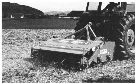
Fig. 16: Travail superficiel et intensif du double rotor à dents (Dyna).
