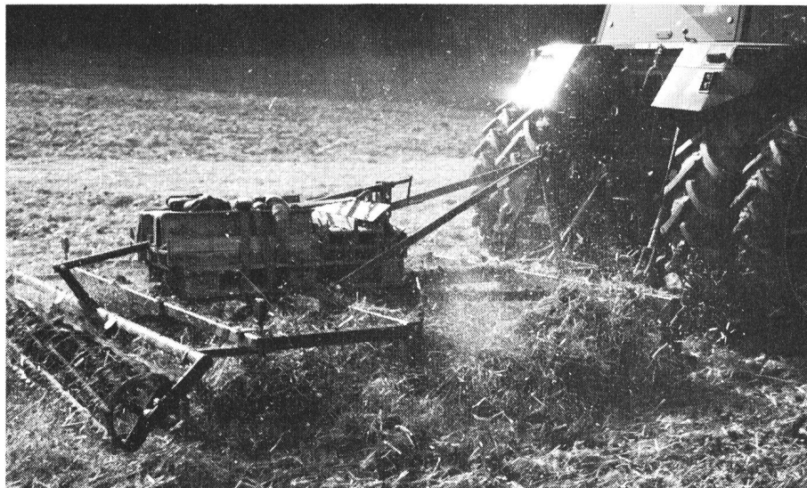
Fig. 12: Herse à bèches roulantes (Kron). La paille hachée court peut être enfouie sans problèmes alors que la paille longue risque de s'enrouler sur les arbres. Le poids supplémentaire (420 kg) a fortement augmenté l'intensité de travail.
