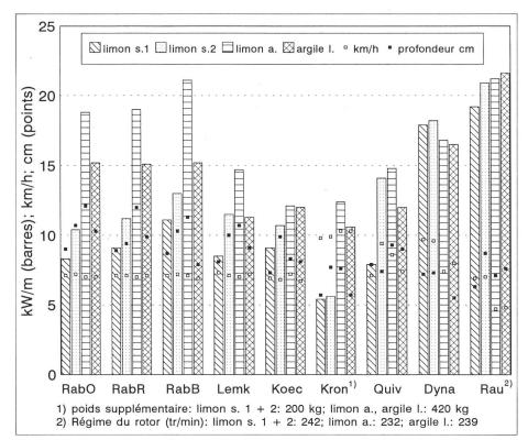
Fig. 5: Puissance mesurée par mètre de largeur de travail (kW/m) sur limons sableux 1 et 2, limon argileux et argile limoneuse, avec indication de la profondeur de travail (cm) et de la vitesse d'avancement (km/h).
