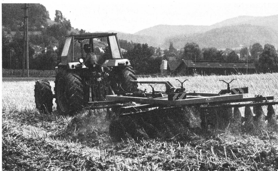
Fig. 15: La herse à disques (Quiv) travaille la surface entière, ce qui permet de bien saisir les adventices. Grâce aux roues support, la profondeur de travail choisie a toujours pu être maintenue constante.
