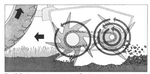
Fig. 17: Double rotor à dents, autoanimé (Dyna). Le rotor avant actionne le rotor arrière par une chaîne dans le rapport 1 à 3. Les rotors s'engrenant empêchent tout bourrage (photo: Bomford).
