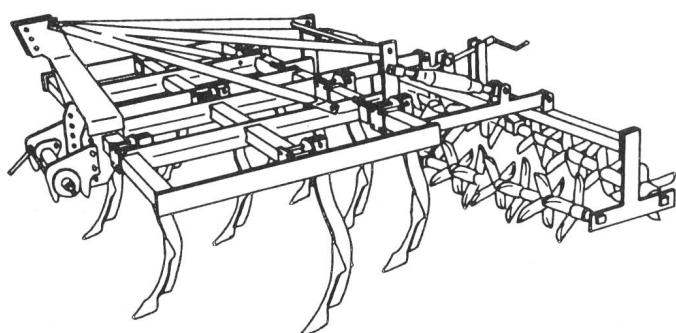
*Le châssis du nouveau culti-groupe Taïga d'Althaus est plus stable qu'un châssis de chisel traditionnel.*
