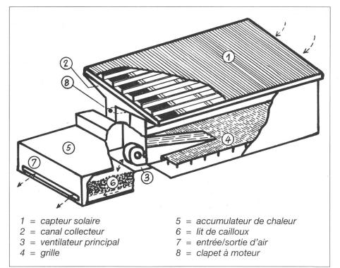
Fig. 1: Schéma d'une installation de ventilation du foin avec capteur solaire et accumulateur de chaleur.
