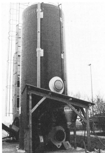
Fig. 1: Pour conserver les grains ensilés à plus de 60% de MS, il faut un silo parfaitement étanche en polyester vitrifié (GFK) ou en acier.
