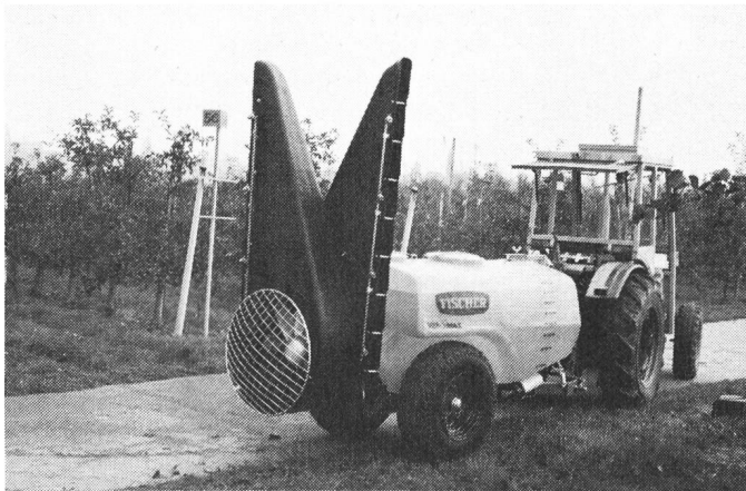
La manipulation et le réglage du diffuseur à flux transversal s'avèrent plus aisés mais il est limité à une hauteur de trois mètres et à un terrain plat.
