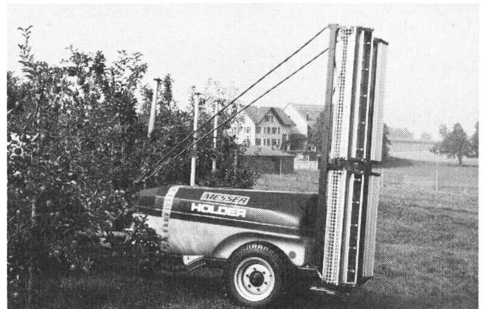
Ce diffuseur à flux axial avec souffleur engendre également un flux d'air horizontal. Les deux ailes peuvent être réglées hydrauliquement, ce qui permet des corrections dans les pentes ou une adaptation en fonction de la forme du feuillage.
