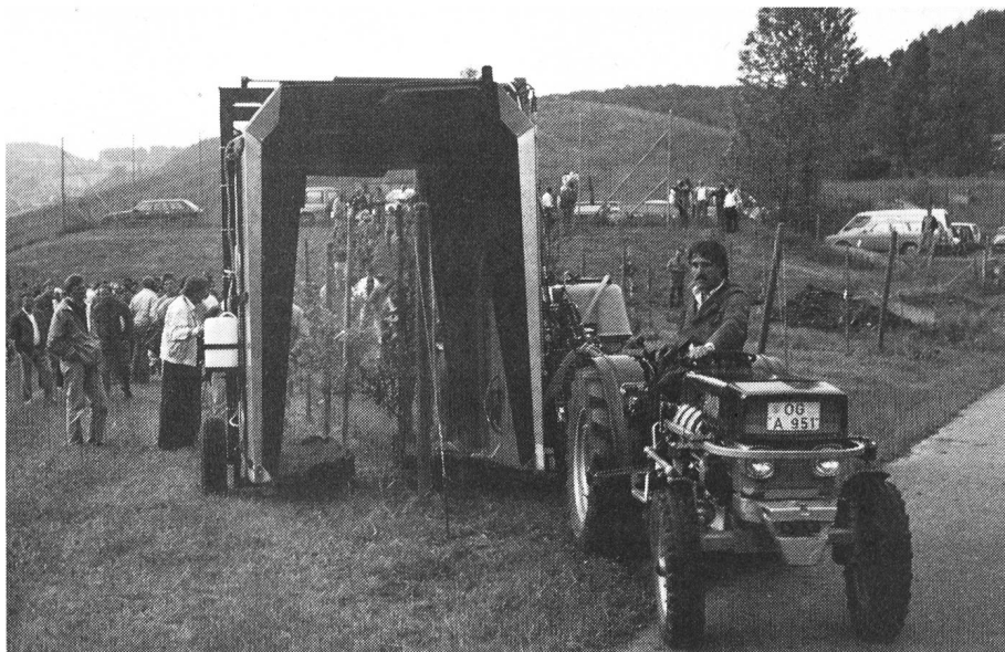
Le diffuseur en tunnel permet le recyclage du produit, ce qui réduit sensiblement les pertes. Cette réduction peut être évaluée à quelque 30-40%.
