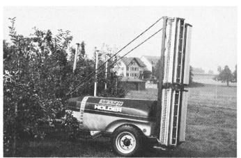
Ce diffuseur à flux axial avec souffleur engendre également un flux d'air horizontal. Les deux ailes peuvent être réglées hydrauliquement, ce qui permet des corrections dans les pentes ou une adaptation en fonction de la forme du feuillage.
